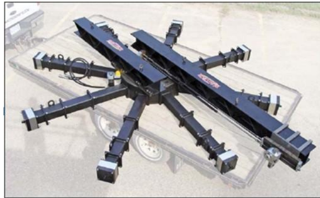
LDFM 5000 Planbearbeitungsmaschine für große Durchmesser
