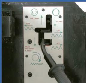
Control de máquina de tubería con velocidad de rotación, avance y presión de sujeción.
